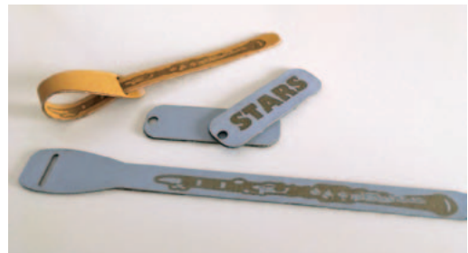
図14 レーザー加工（彫刻）
