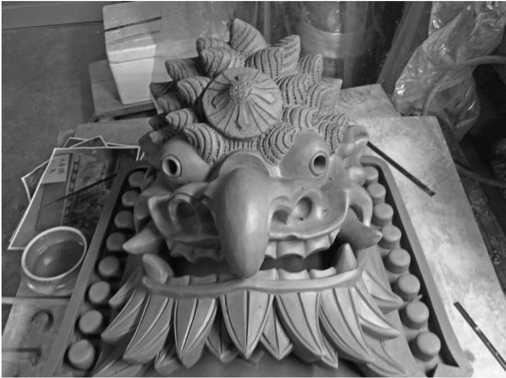
図7. 白地状態のからす天狗鬼瓦（乾燥後、焼成する。焼成した姿が図5）
