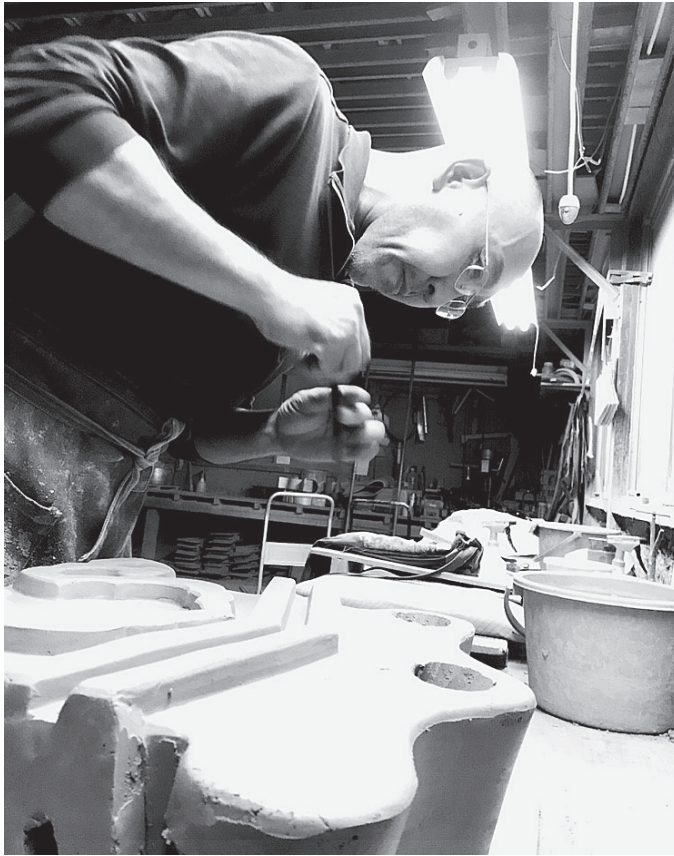
図7 鬼瓦制作中の伊藤秀樹 伊藤鬼瓦店工場内
