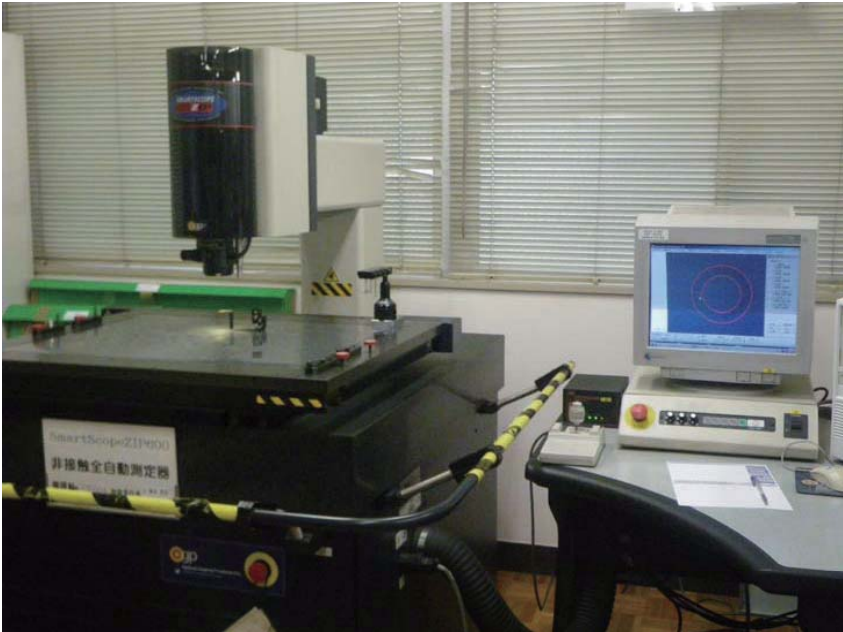
写真5 平出精密にあったコンピューター制御の接触・非接触三次元計測器
