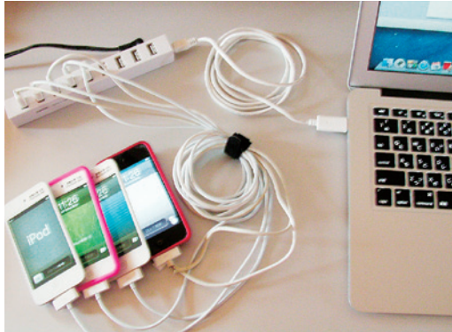
図1 iPodTouch USBハブ（セルフ電源仕様）とノートパソコン
