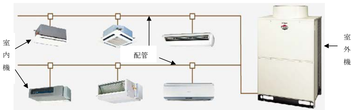
図2-1 業務用空調機（マルチエアコン）のイメージ図
