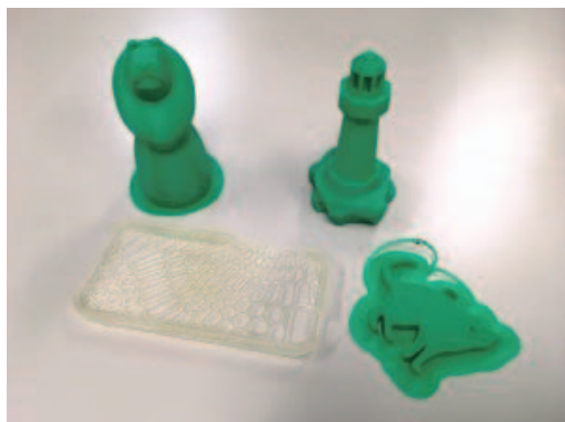
図2 ABSを利用した造形物
