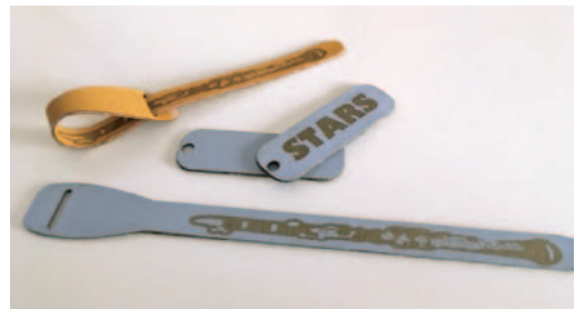
図14 レーザー加工（彫刻）
