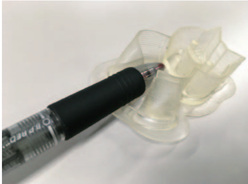
図4 フレキシブルレジンを利用した造形物
